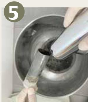
Bauen Sie **alle Teile** **auseinander** und **reinigen** Sie diese mit Wasser und eventuell ein wenig Spülmittel. Das geht am besten in einem (anderen) Waschbecken, in der Dusch- oder Badewanne. Achten Sie insbesondere darauf, dass die Dichtungsringe nicht verloren gehen!
