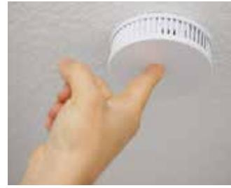
Drücken Sie zum Beenden des Alarms mit dem Finger, einem Besenstiel oder einem Stock fest auf die Prüftaste.
